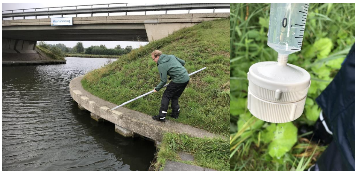
Figuur 2. A) Monstername met een monsterhengel, B) de opschroefbare spuitkop met daarin het PES filter.
